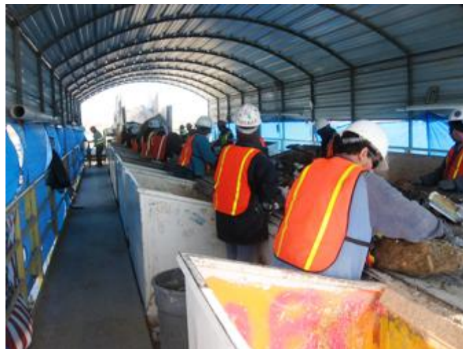
Слика 6.15. Пример једне линије за сепарацију рециклабилног отпада
