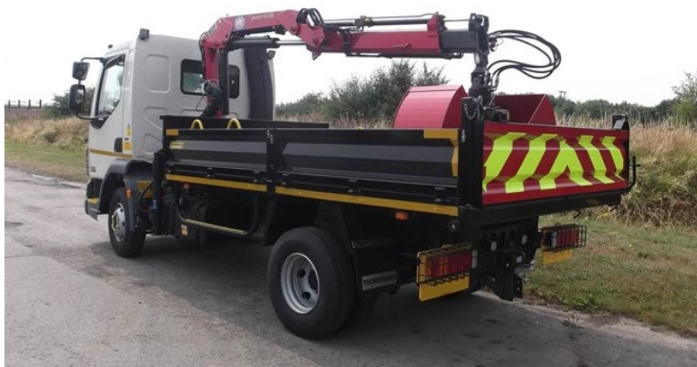
Слика 6.8. Пример камиона отвореног типа са краном (хидрауличном „руком“) за сакупљање зеленог отпада из паркова и јавних површина
